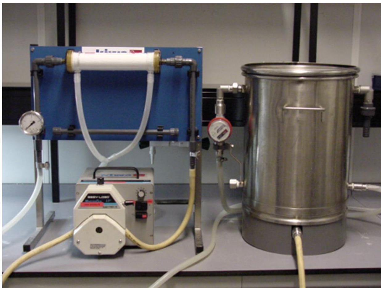
Figuur 1 hemoflow opstelling. Water uit het monstervat wordt door het hemoflow membraan gepompt, waarbij het permeaat wordt afgevoerd, en het concentraat wordt teruggevoerd in het monstervat. Het monstervat wordt bijgevuld met te bemonsteren water via een vlotter.
